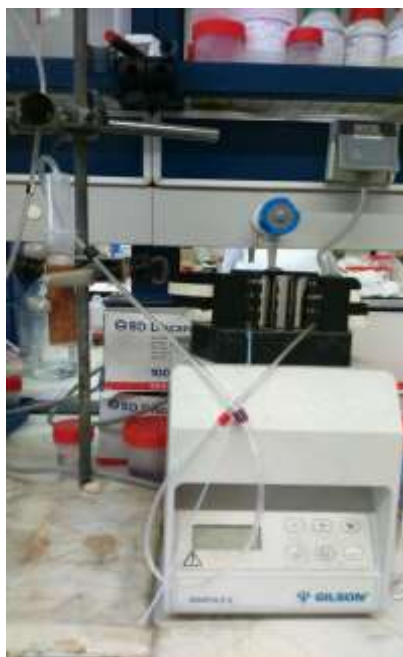
Figura 4.8. Montaje del ensayo de adsorción en continuo en columna.
