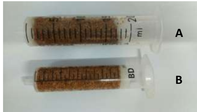
Figura 4.5. Columnas de corcho utilizada en el estudio. Columna compactada al 26% (A) y al 43% (B)
