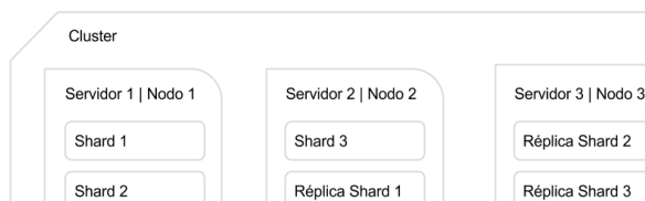
Figura 5. Esquema de un clúster Elasticsearch compuesto por tres nodos con tres shards y una réplica de cada uno de ellos.
