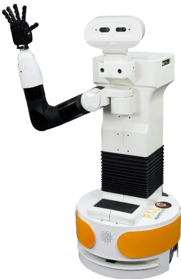
TIAGo es un robot móvil que se puede utilizar para la investigación en manipulación, tareas colaborativas e interacción Humano-Robot.
