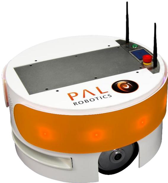
PMB-2 es una base móvil de carga útil de 50 kg que se puede utilizar en logística, industria o investigación. También se puede usar como plataforma para su propia solución robótica.
