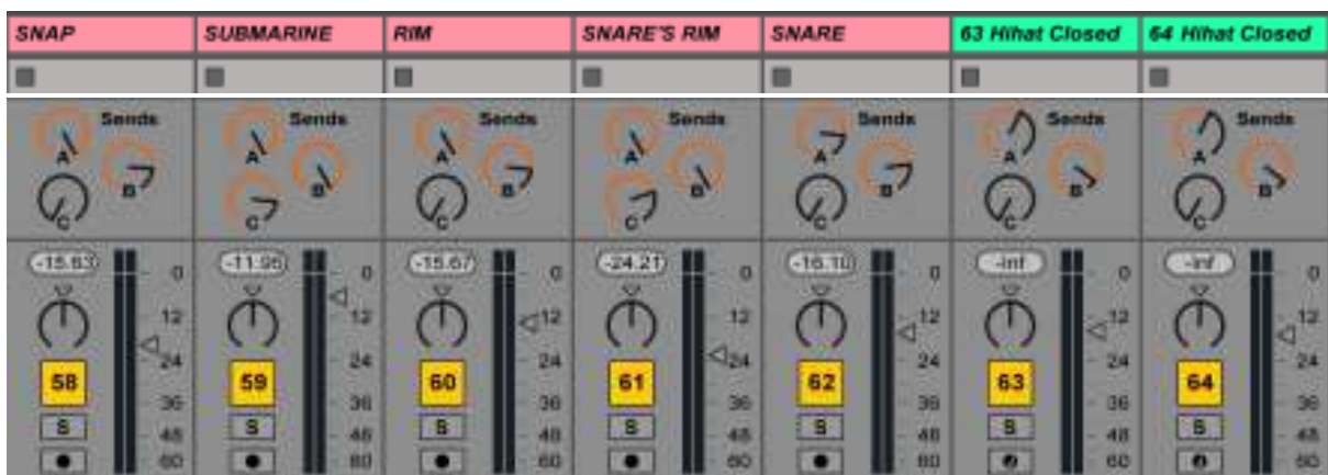
Figura 45. Vista en vertical de las pistas, donde puede verse de forma visual la configuración de la reverberación en cada una de ellas, a través de canales de retorno. Fuente: Elaboración propia, (2018)
