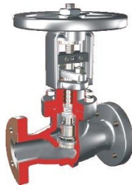
Figura 14: Representació gràfica d'una vàlvula de seient
