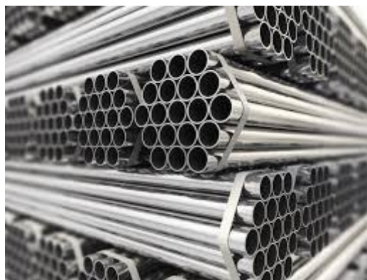
Figura 4.3 Tuberías de AISI 316
