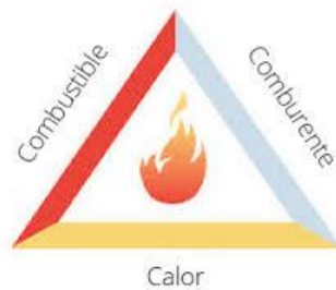
Figura 5.23. Triángulo del fuego.
