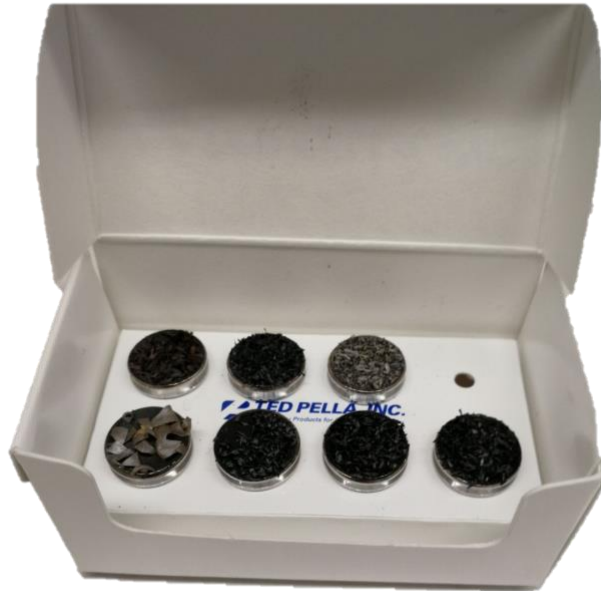
Figura 16: Preparació de les mostres per la Microscòpia Electrònica d'Escombrat (SEM).
