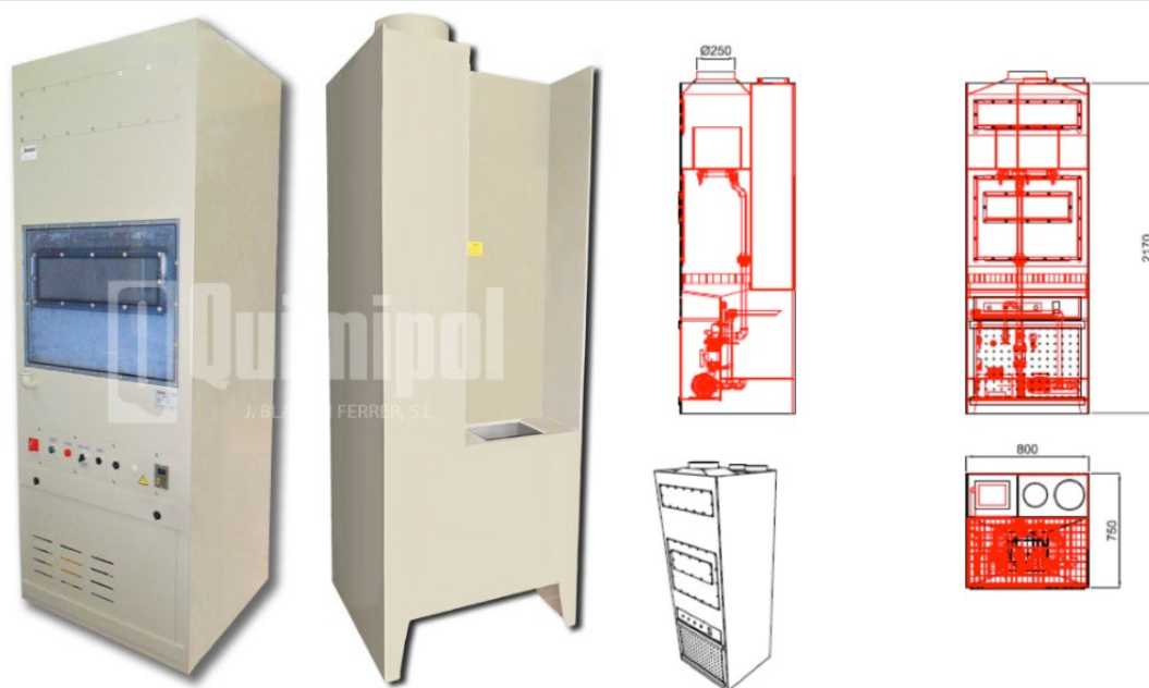
Figura 6.5-1. Modelo del Scrubber Quimipol para tratar los gases de la producción la planta.
