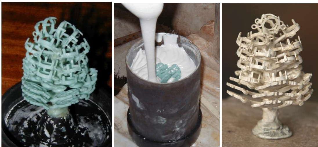
Figuras 36, 37 y 38. Proceso de revestimiento de yeso de un árbol de cera a un árbol de plata.
