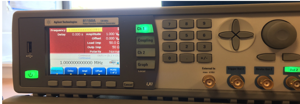
Figura 14. Generador de pulsos de Keysight modelo 81150A para la elaboración del tipo de señal y ruido para aplicar a la muestra de memristor.
