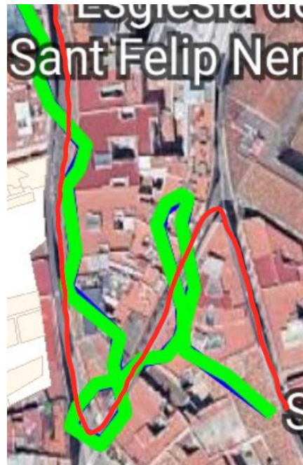
Imagen 15 – Recorrido original (rojo) con localizaciones de GPS (azul) y GPS + Filtro de Kalman (verde)
