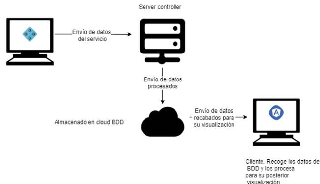
Fig. 1: Diagrama básico de los elementos del sistema
