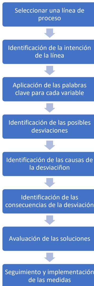
Figura 12. Esquema del funcionamiento de un HAZOP.
