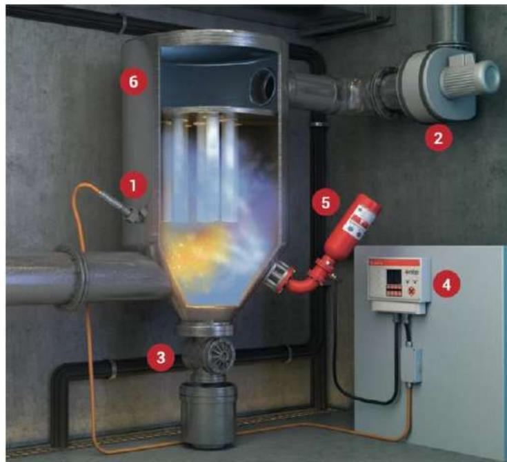
Figura 8. Sistema HRD de supresión de atmosferas explosivas.
