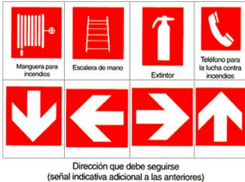
Figura 5.8 Señales relativas a los equipos de lucha contra incendios
