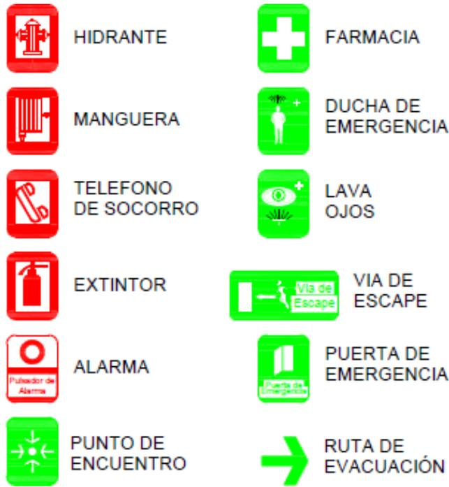
Figura 10.1.1. Significado de las señales en diagrama de implementación de plan contraincendios y evacuación.
