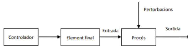
Figura 2: Esquema d'un llaç de control obert ( Open loop ) [1].
