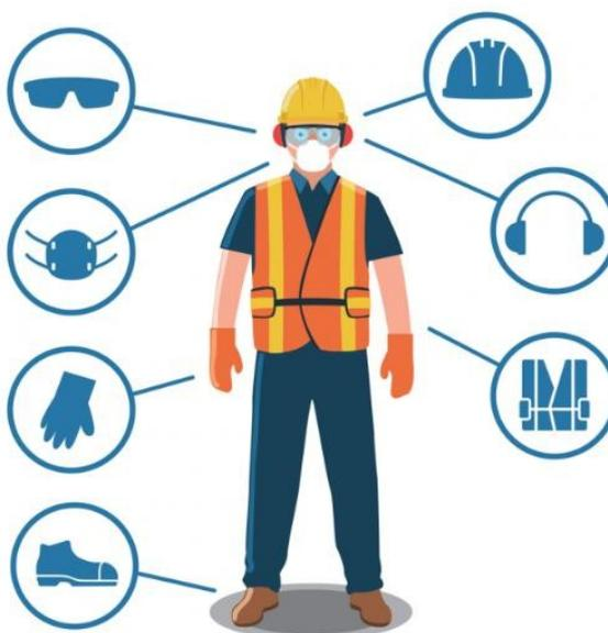
*Figura 5.25. Equipos de protección individual.*
