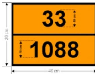
**Figura 5.11.** Panel de identificación para el transporte de sustancias.
