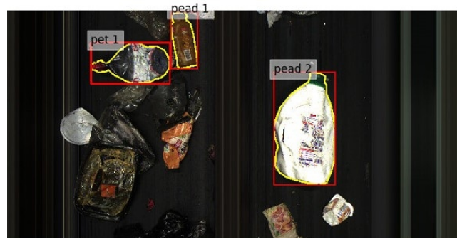
Fig. 1: Mostra de detecció d'objectes del dataset Ecoparc amb els perímetres i bounding boxes del ground truth
