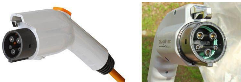
Ilustración 7. Conector Tipo 1 (SAE J1772)
