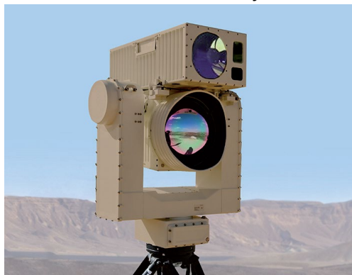
Figura 19. Cámara EO e IR del sistema Drone Dome. (Rafael, 2019)
