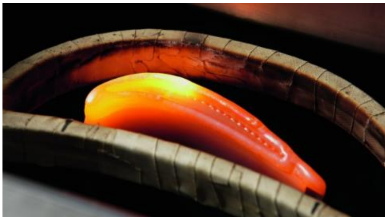
Ilustración 19 Recrecimiento de punta de álabe mediante soldadura Fuente: Siemens Energy
