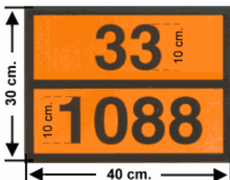
Figura 16: Mesures estàndard dels panells dels vehicles destinats al transport de substàncies químiques perilloses. [20]
