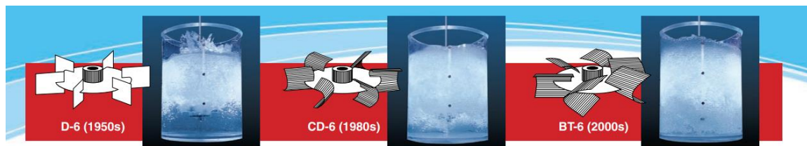
Figura 3. Operació de diversos tipus d'agitadors (el primer, agitador Rushton, el darrer, l'agitador seleccionat). (Font: Chemineer)
