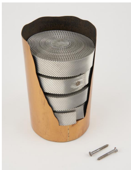
Figura 6: Rebliment dels regeneradors de Fränkl
