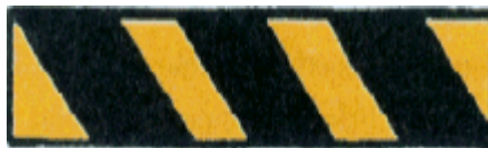
Figura 22. Senyalització amb risc de caigudes, xocs o cops
