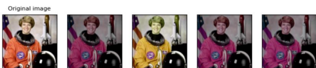
Fig. 5. Efectos de la transformación ColorJitter. Fuente: https://pytorch.org/ (Illustration of Transforms – Torchvision 0.10.0 Documentation, s.f.)
