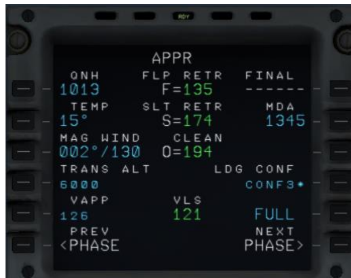
Figura 7.7. Pantalla PERF para la aproximación RNP en la MCDU del A320 de la simulación.
