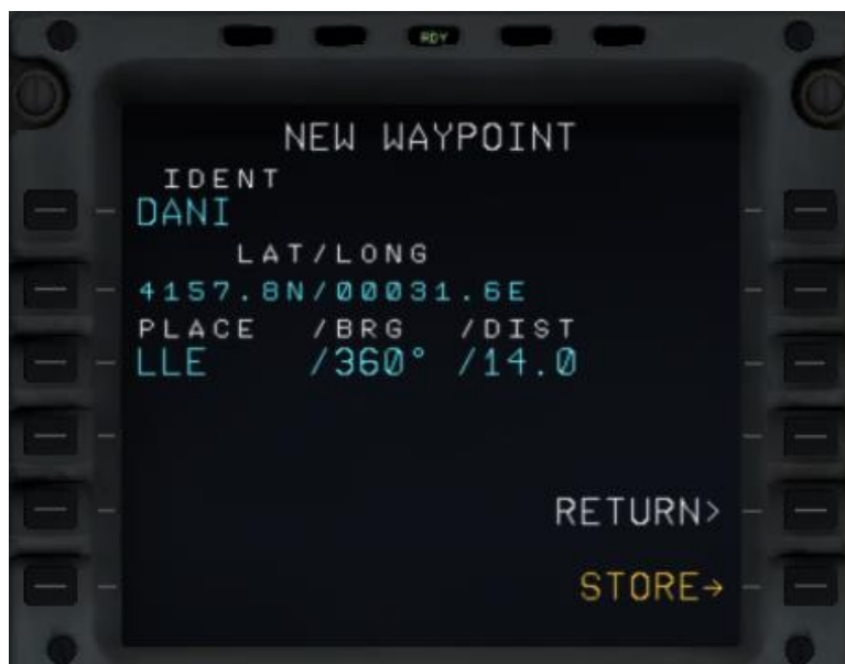
Figura 6.11. Creación de un punto de ruta. Pantalla DATA del MCDU Airbus A320.
