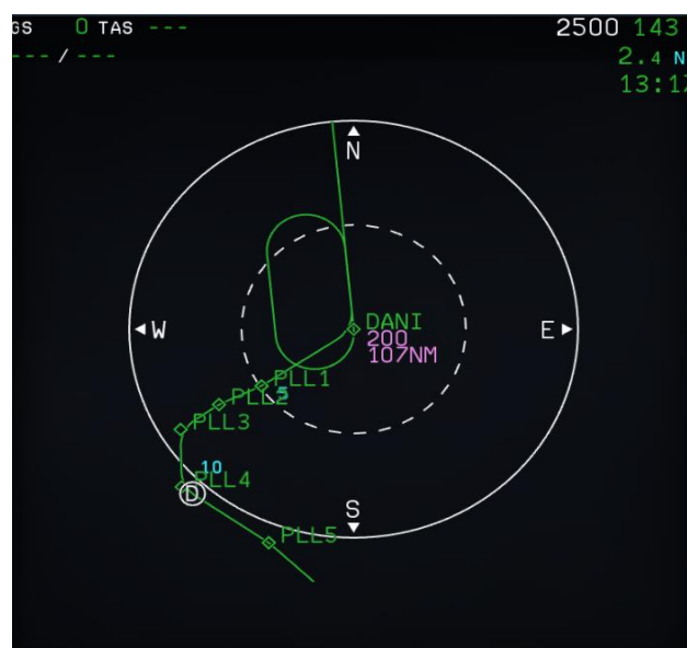
Figura 7.6. Trayectoria de aproximación con espera en el punto DANI. ND A320.
