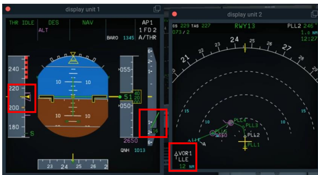
Figura 7.9. PFD y ND del A320 en punto PLL2 de la simulación.
