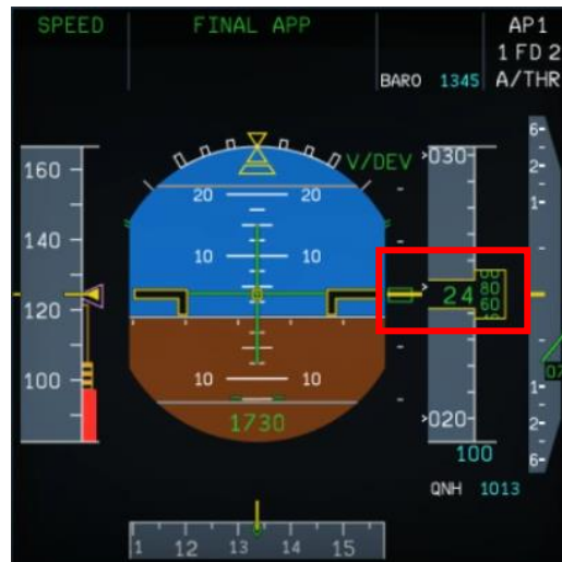
Figura 7.15. PFD del A320 en la milla 4 de la simulación.
