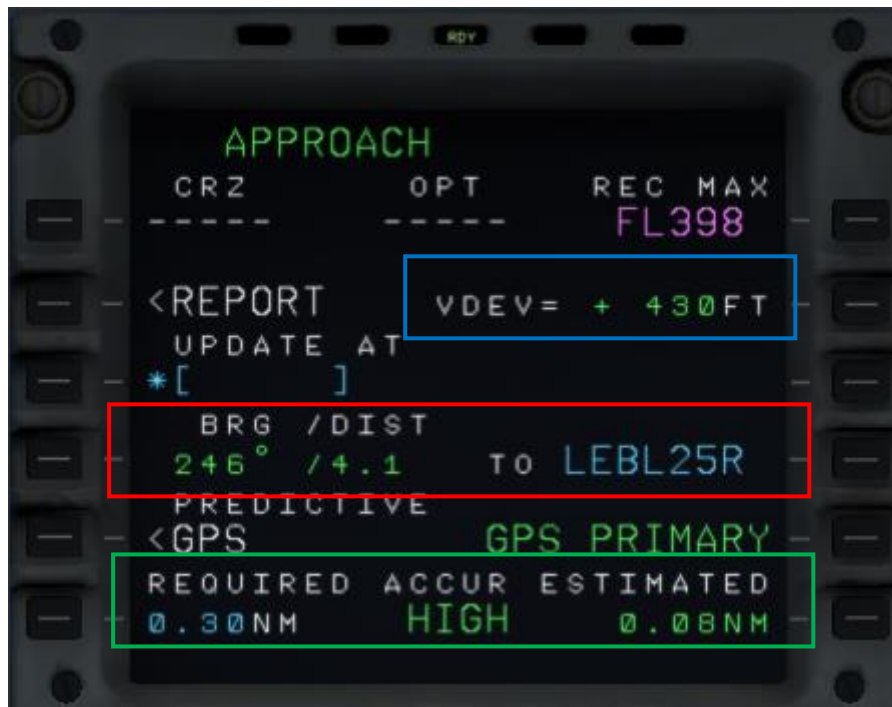
Figura 6.16. Pantalla PROG para la aproximación del MCDU Airbus A320.
