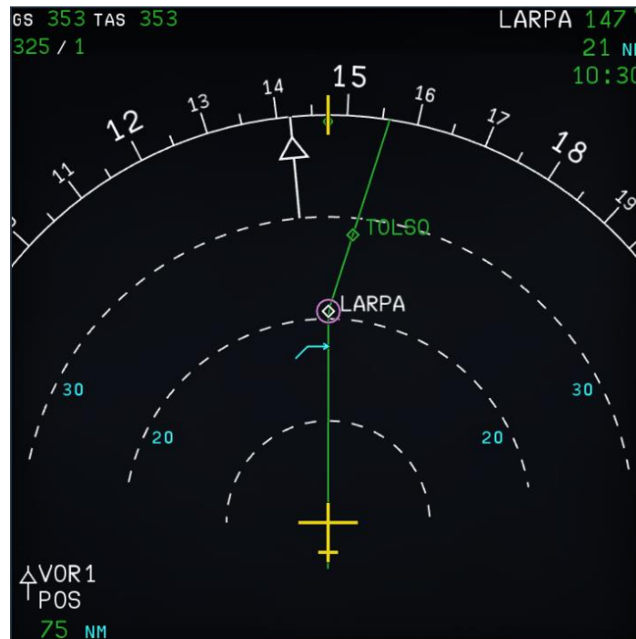
Figura 6.7. Navigation Display Airbus A320.
