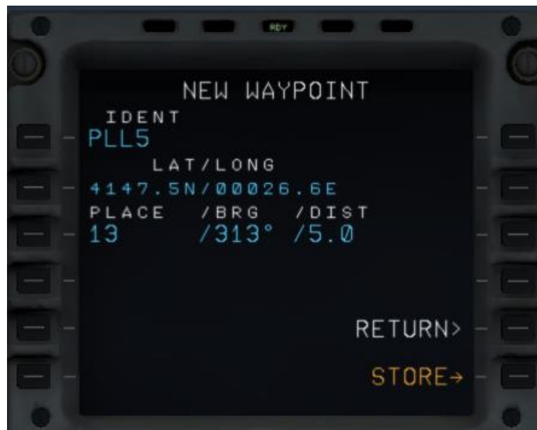
Figura 7.2. Creación del punto PLL5 de la aproximación RNP en la MCDU del Airbus A320.
