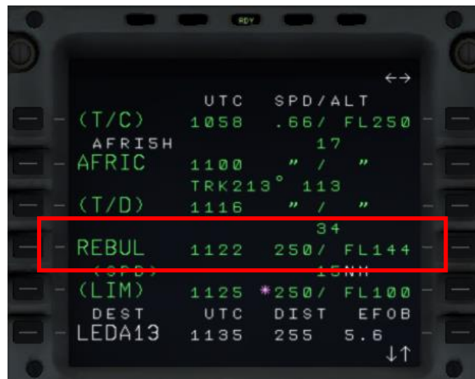
Figura 6.12. Pantalla F-PLN del MCDU Airbus A320.
