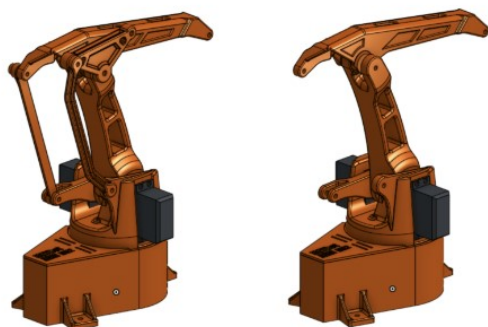
Fig. 36: Montaje del brazo y antebrazo - Fuente: Instructables, 2019
