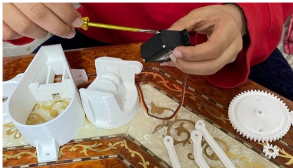
Fig. 34: Colocación del servo, fuente propia
