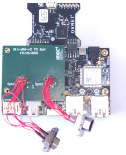
Fig. 10: PCB connectada al mòdul HS del dispositiu.
