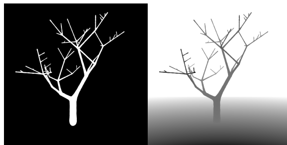
Fig. 5: Imatges que rep el sistema de determinació de l'estructura com a inputs. A l'esquerra, la màscara que indica quins píxels corresponen a l'arbre, i a la dreta, la imatge en escala de grisos que indica la distància de la càmera al píxel en qüestió.
