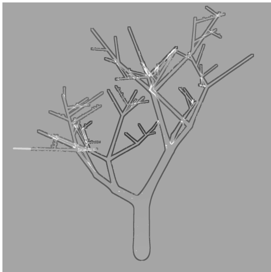
Fig. 18: Imatge que mostra les diferències entre la profunditat real de la imatge i la profunditat calculada per la visió estereoscòpica. El gris indica que el valor calculat i el real són iguals. Els colors foscos indiquen que la profunditat calculada és més gran que la profunditat real, mentre que els colors clars indiquen que la profunditat calculada és menor que la profunditat real.
