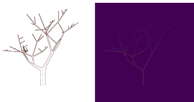
Fig. 10: A l'esquerra, imatge que mostra els contorns de l'arbre en negre, l'esquelet de l'arbre en vermell, i els punts on es separen les branques en groc. A la dreta, les diferents branques detectades i separades, cadascuna amb un color diferent segons el seu índex.
