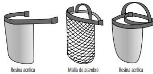
Figura 34: pantalles facials per treballar a temperatures elevades
