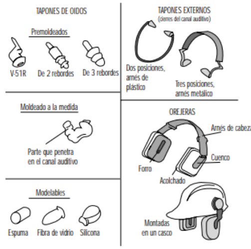
Figura 36: exemples de diferents tipus de protectors auditius
