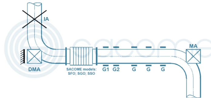
Figura 5 Moviment axial absorbit per la junta de dilatació
