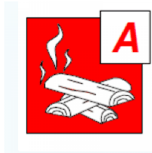
Figura 5.4: Clase de incendio tipo A
