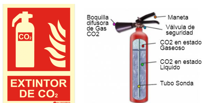
Figura 5.15: Señalización de extintor CO 2 y su disposición interior
