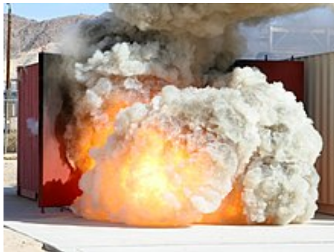
Figura 5.21: Explosión no confinada
