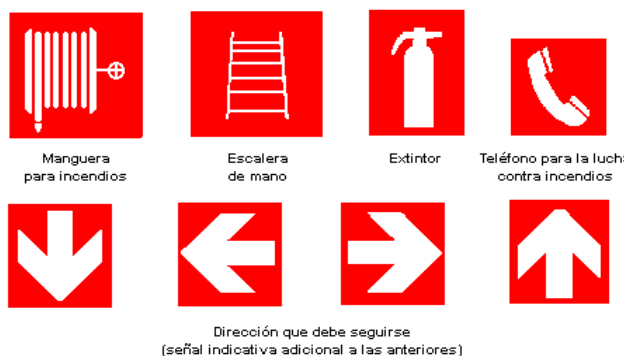
Figura 14: Señales relativas a los equipos de lucha contra incendios.
