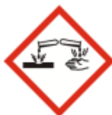
Figura 8: Pictograma de sustancia corrosiva
