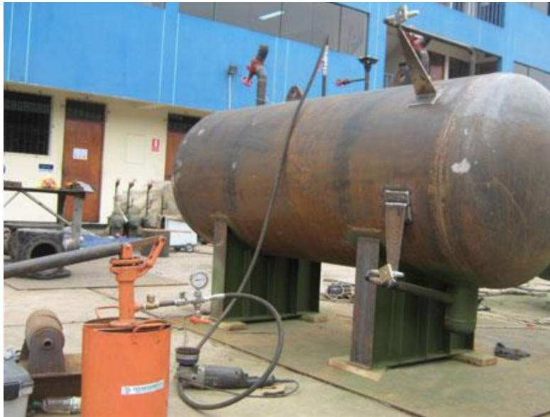
Figura 8.1.- Exemple real proves hidroestàtiques.
