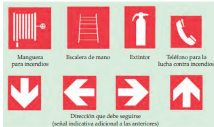
Figura 5.18.- Senyals relatives als equips de lluita contra incendis presents a la planta seguint el INSST.
