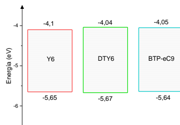
Figura 12 Diferencia de energética entre los orbitales HOMO y LUMO de los diferentes NFA
