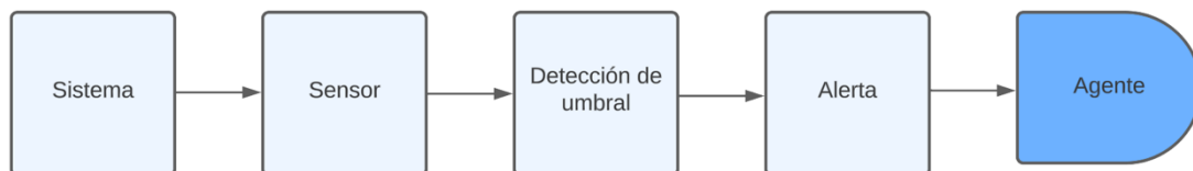
Figura 8: Esquema general de un sistema de alerta (Sáez Nieto, 2012)
