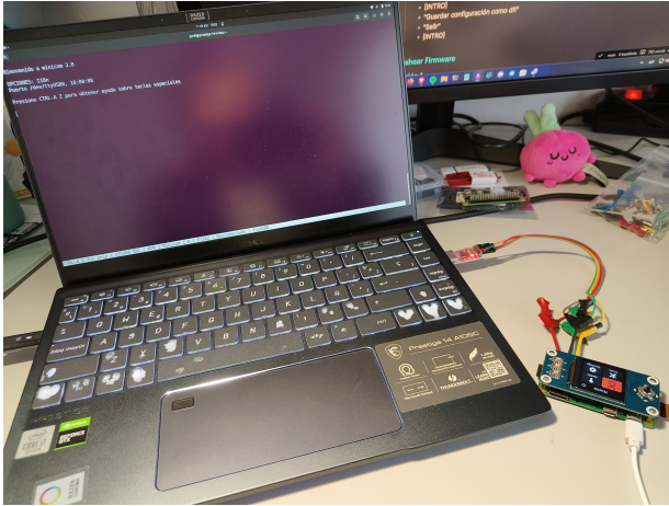
Fig. 3: Intentando obtener una consola mediante UART
