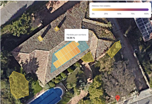
Fig. 5: Afectación sombras en los módulos
