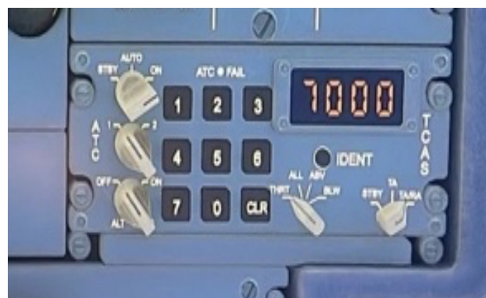
Figura 12. Transponder de un A320, extraído del simulador Flight Simulator [12].
