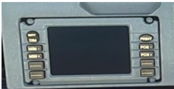
Figura 9. Controller-Pilot Data Link Communications de un A320, extraído del simulador Flight Simulator [9].
