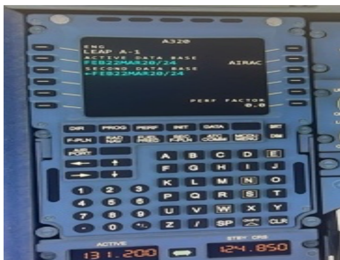
Figura 10. Multipurpose Control and Display Unit de un A320, extraído del simulador Flight Simulator [10].
