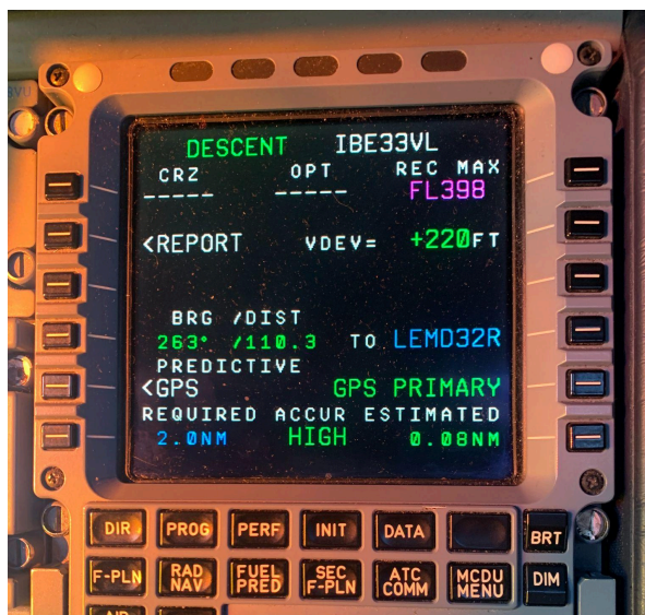
Figura 6. Captura de la MCDU mostrant l'aplicació real de l'error requerit PBN i l'estimat en espai aeri RNP 2.
