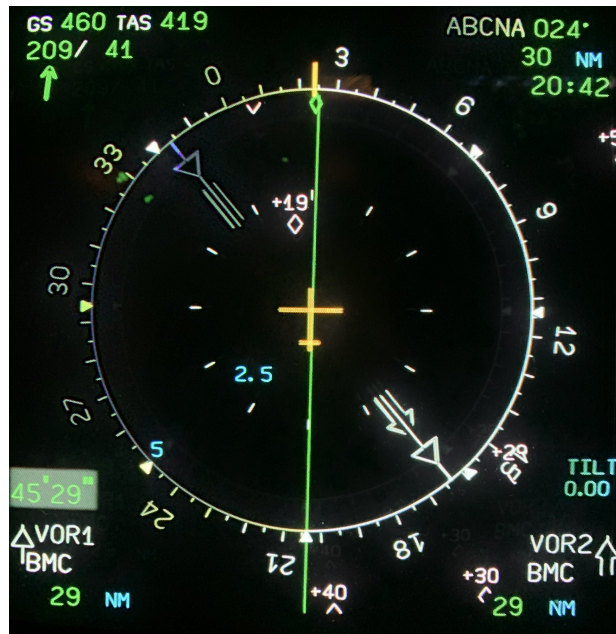
Figura 17. Imatge de la pantalla de Navegació mostrant la proximitat d'un altre avió, 2000 peus de separació, cas A.
