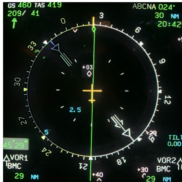
Figura 18. Imatge de la pantalla de Navegació mostrant la proximitat d'un altre avió, 300 peus de separació, TCAS desactivat.
