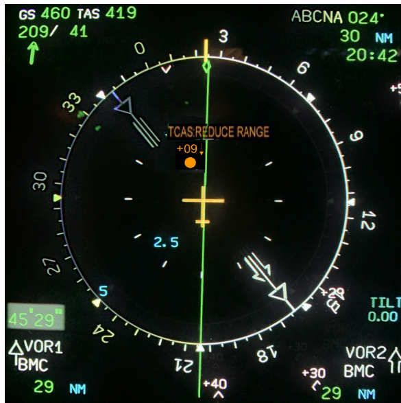
Figura 20. Imatge de la pantalla de Navegació mostrant la proximitat d'un altre avió, 900 peus de separació i alerta de proximitat TCAS.
