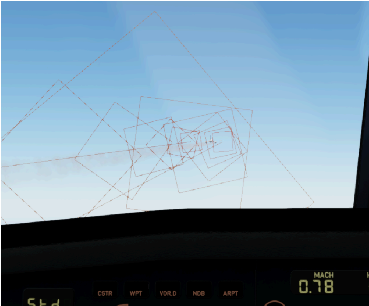
Figura 36. Captura de la simulació del cas pràctic on s'observa l'avió líder desde la perspectiva de l'avió seguidor i els vòrtex generats sintèticament per a la visualització i posicionament òptim.
