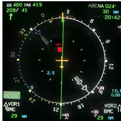
Figura 21. Imatge de la pantalla de Navegació mostrant la proximitat d'un altre avió, 1 NM i 100 peus de separació i alerta de proximitat TCAS.
