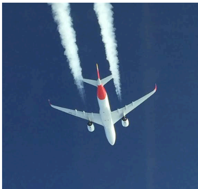
Figura 39. Imatge capturada que representa visualment desde la perspectiva del seguidor el rendez-vous del Fello'Fly darrere d'un A350.
