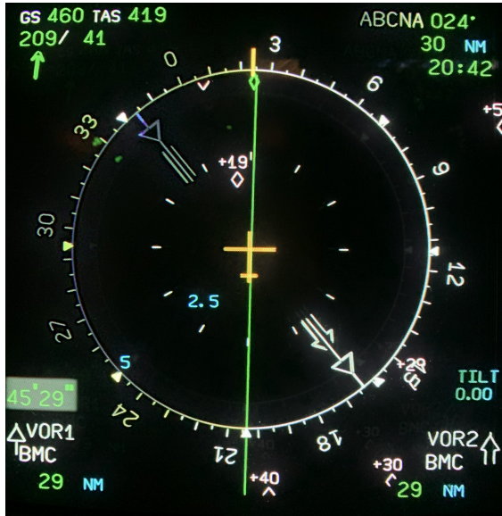
Figura 19. Imatge de la pantalla de Navegació mostrant la proximitat d'un altre avió, 2000 peus de separació, cas B.
