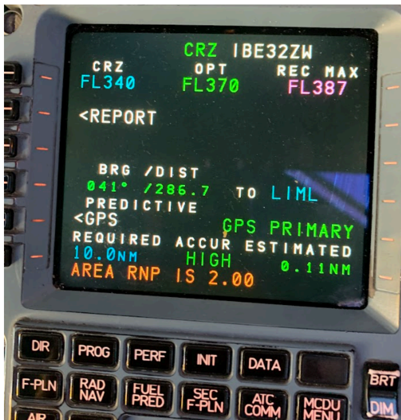
Figura 35. Imatge de la MCDU rebutjant requisits RNP10 en estar sobrevolant un espai aeri RNP 2.
