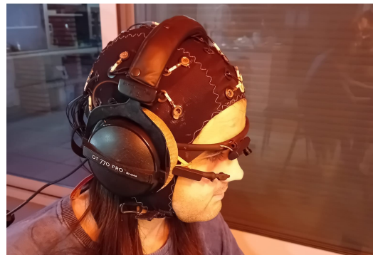
Figura 1: Imatge d'un subjecte amb el material per realitzar les mesures: eye-tracker, electroencefalograma i auriculars.
