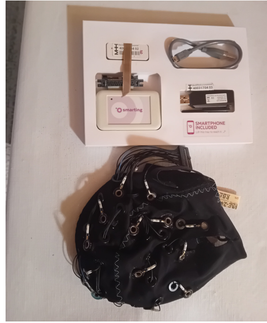
Figura 4: Imatge de Smarting de la marca mBrainTrain el sistema d'electroencefalografia utilitzat. Disposa de 24 elèctrodes que es connectem a un amplificador que envia el senyal al nostre dispositiu mitjançant un pendrive amb connexió Bluetooth.
