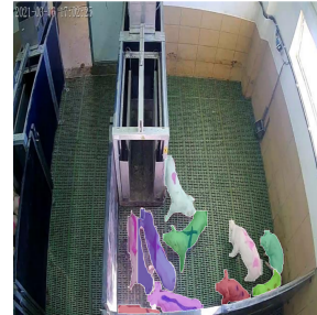
Fig. 5: Exemple de resultats erronis del primer model amb dataset generat amb SAM: màscara que agrupa més d'un porc
