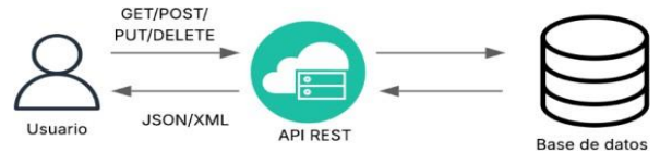
Fig. 2. Diagrama de funcionamiento de API REST
