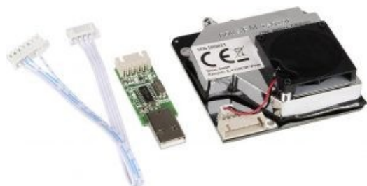
Figura 41: Sensor de partícules en suspensió (PM 2.5 – PM 10 ) – SDS011
