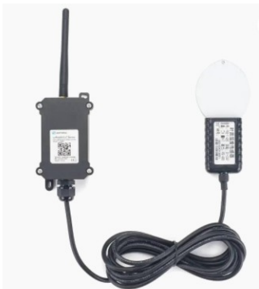
Figura 12: DRAGINO NLMS01 Sensor d'humitat NB-IoT
