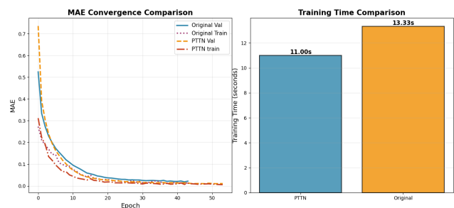
Fig. 5: Gràfiques comparatives de temps i convergència d'una arquitectura elemental MLP , per als dos datasets
