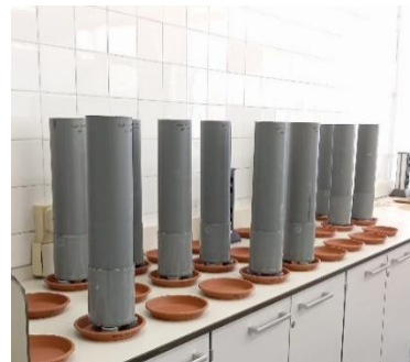
Figura 8. Columnas de lixiviación finalizadas.
