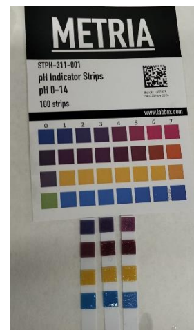
Figura 9. Determinación pH soluciones (2, 3 y 4). Fuente: Elaboración propia.
