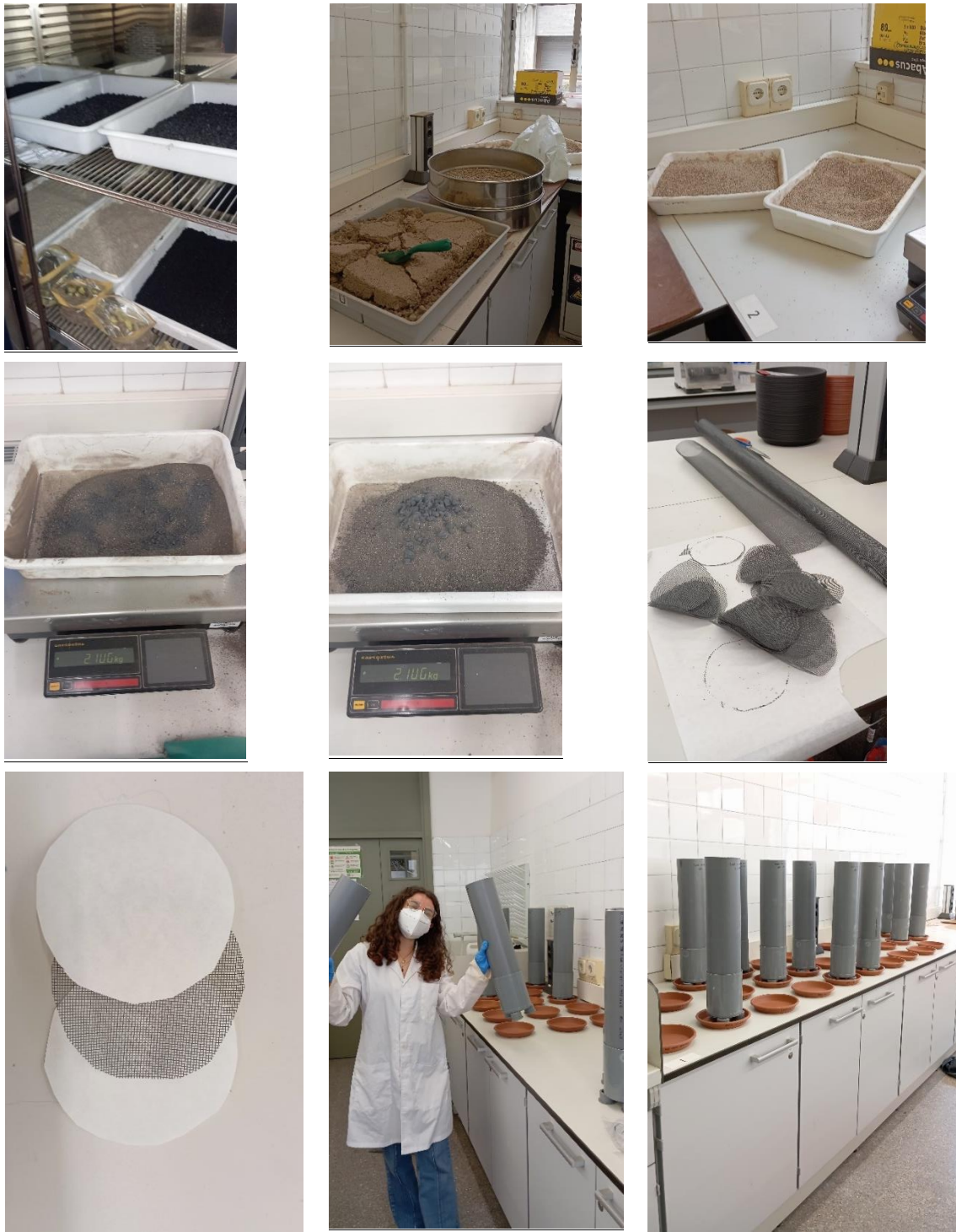
Figuras A12. Conjunto de fotografías del montaje de columnas y puesta de muestras. Fuente: Elaboración propia.
