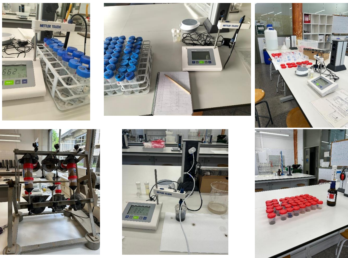
Figuras A18. Conjunto de fotografías de las pruebas de pH de suelos y lixiviados. Fuente: elaboración propia.
