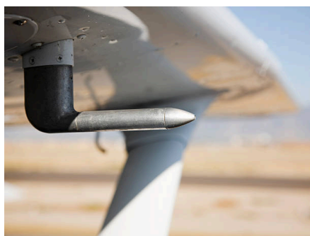
Figura 1: Sondes Pitot, utilitzades per mesurar la velocitat de l'aire.
